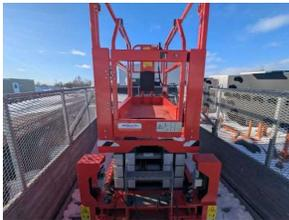
Plateforme élévatrice électrique, sur chenilles
